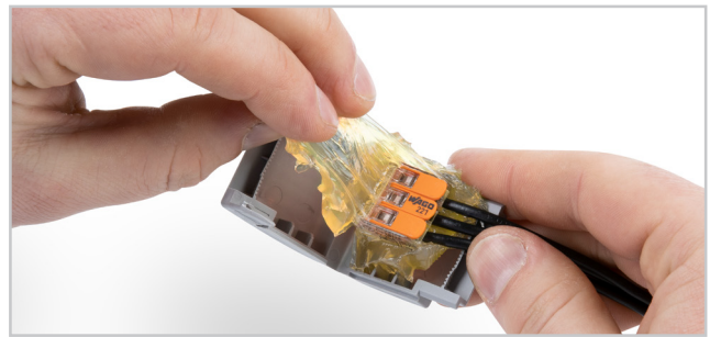
Extension des circuits : Ouvrez la Gelbox et retirez le gel du terminal. Ouvrez le terminal et montez le câble avec les nouveaux composants.
