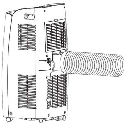
Raccorder à la partie finale du tuyau flexible le raccord circulaire pour fenêtre (1) puis le raccord terminal pour fenêtre (2), ainsi obtenu en réunissant les parties A et B
