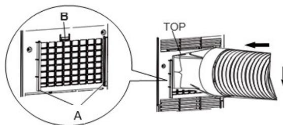
7. La hauteur d'évacuation doit se situer entre 40 cm et 130 cm du sol. Éviter que le tuyau flexible ne soit plié ou excessivement courbé.
