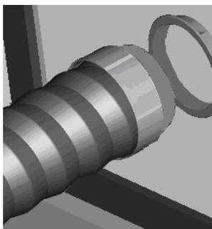
4. Insérer le raccord circulaire sur le tuyau flexible.
