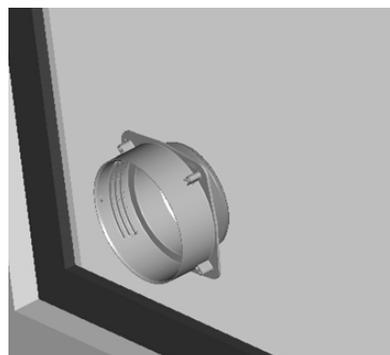
3. Insérer le raccord circulaire pour kit hublot dans le tuyau flexible et insérer le tuyau flexible rétractable avec raccord circulaire dans le hublot sans son bouchon.
