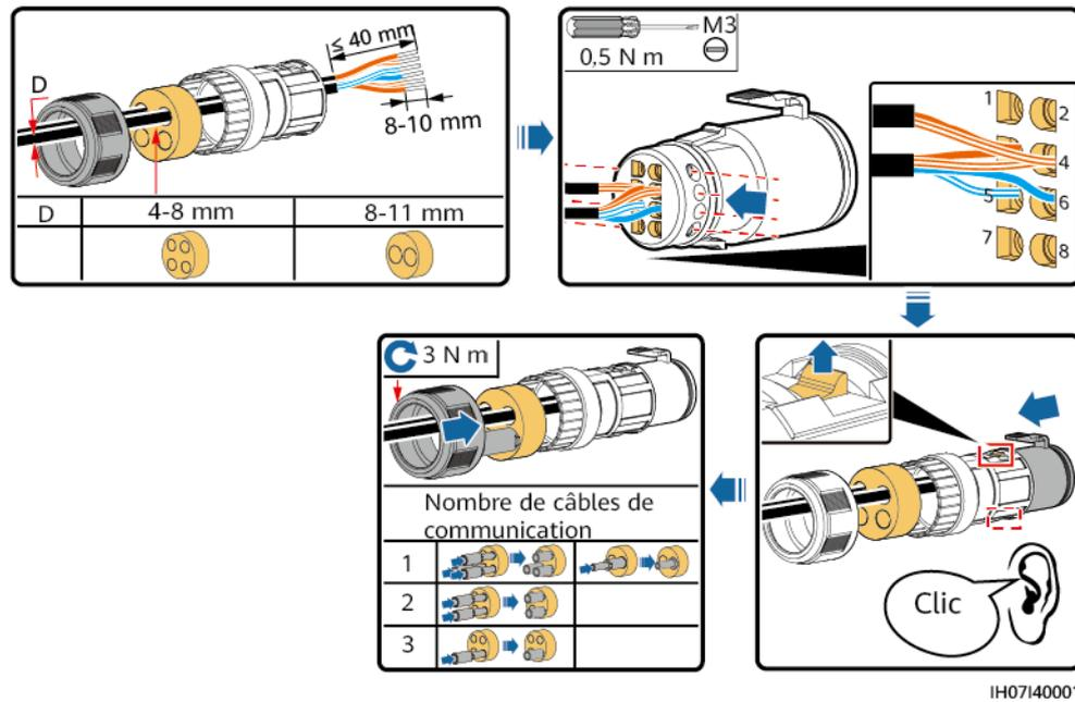
Figure 5-26 Assemblage d'un connecteur de signal (SUN2000 en cascade)
