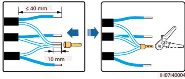
Figure 5-25 Assemblage d'un connecteur de signal (SUN2000 simple)
