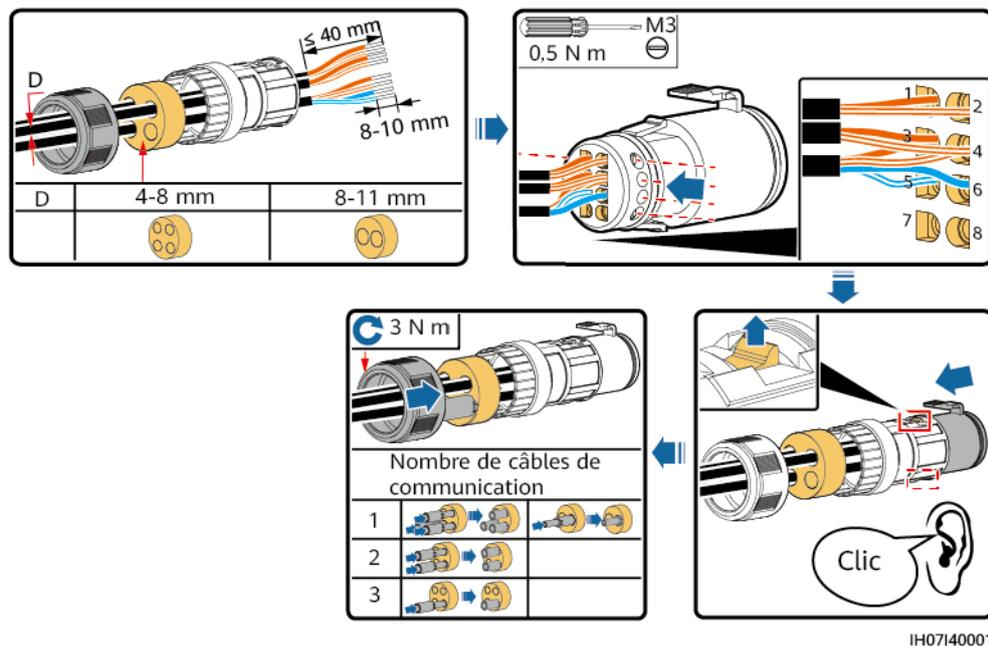
**Étape 2** Raccordez le connecteur de signal au port correspondant.
