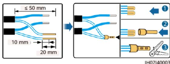
Figure 5-24 Sertissage de trois câbles de signalisation
