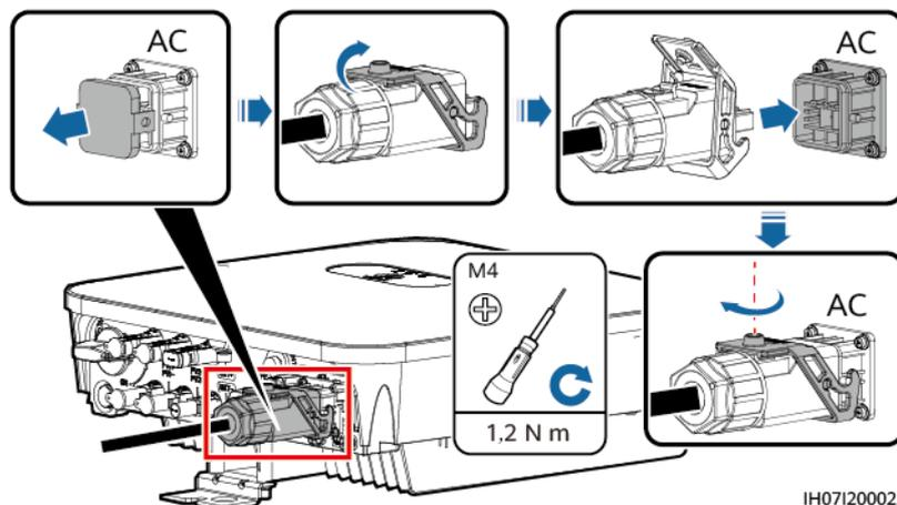
**Étape 3** Vérifiez l'acheminement du câble de puissance de sortie CA.
