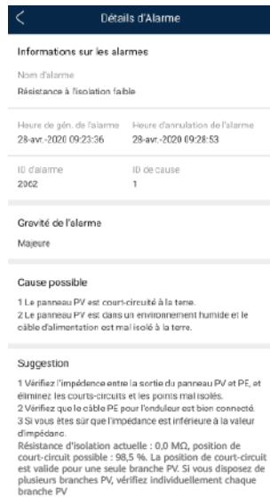
Figure E-1 Détails d'alarme
