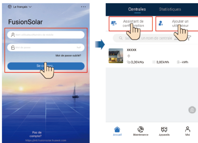
Figure 7-3 Création d'une centrale PV et d'un utilisateur
