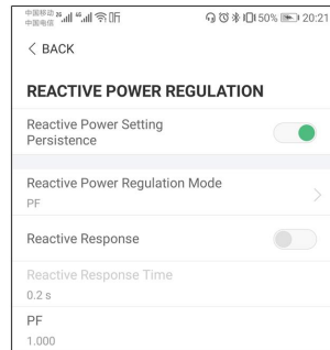
figure 7-18 Régulation de la puissance réactive
